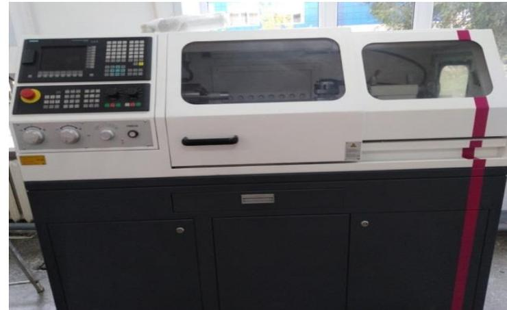
Токарно-винторезный станок с ЧПУ
