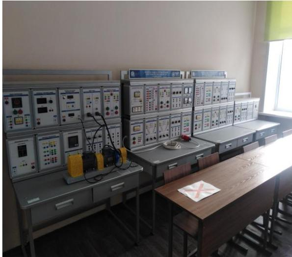
Комплект оборудования «Релейная защита и автоматизация электроэнергетических систем с генератором»
