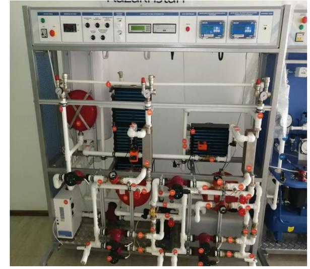
Лабораторная установка «Энергосберегающие технологии. Тепловой насос»
