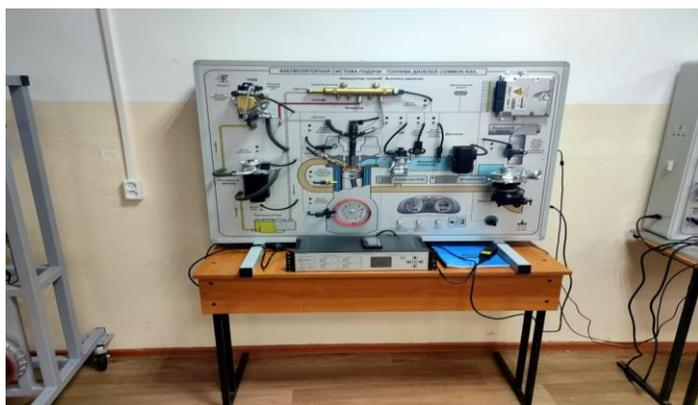
Лабораторный стенд «Дизельная Система управления Common Rail»
