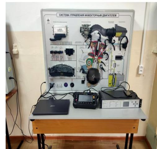
Лабораторный стенд «Система управления инжекторного двигателя»
