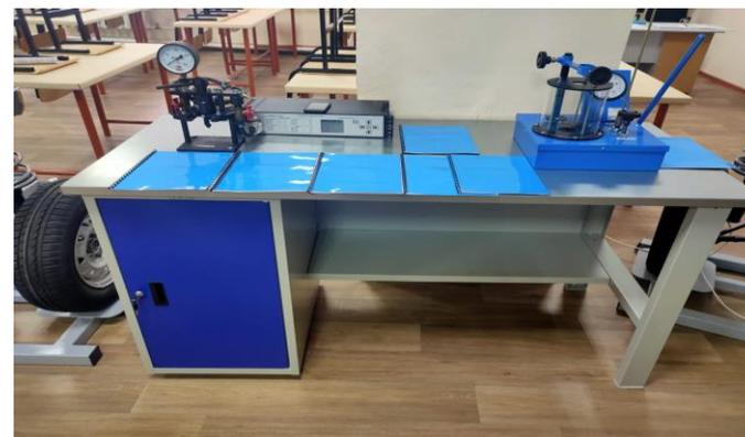
Лабораторный стенд «Диагностика топливных форсунок и плунжерных пар дизеля»
