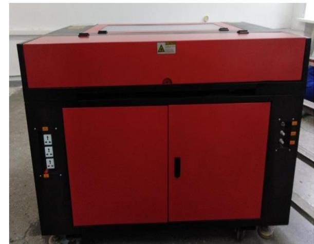
Лазерный станок с ЧПУ «CHIGUANG»
