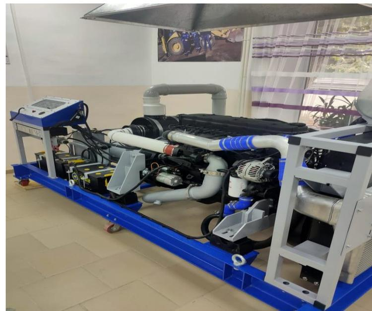
Лабораторный стенд «Действующий двигатель грузового автомобиля Cummins»
