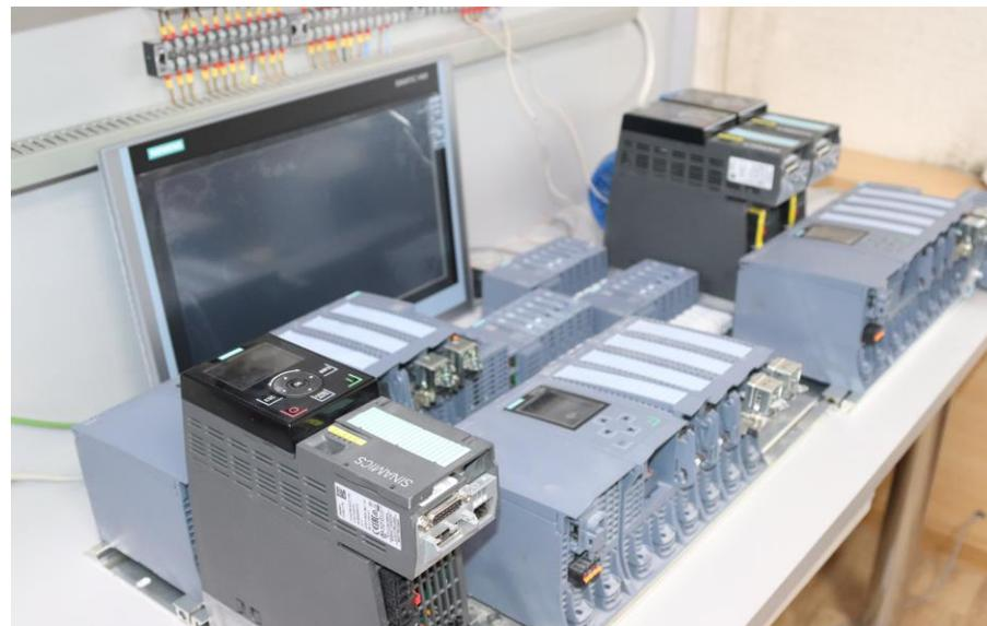
Преобразователь частоты «SINAMIC S G110»
