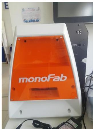
Фрезерно-гравировальный станок для печатных плат «MonoFab»
