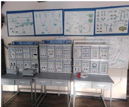
Комплект оборудования «Релейная защита и автоматизация электроэнергетических систем без генератором»
