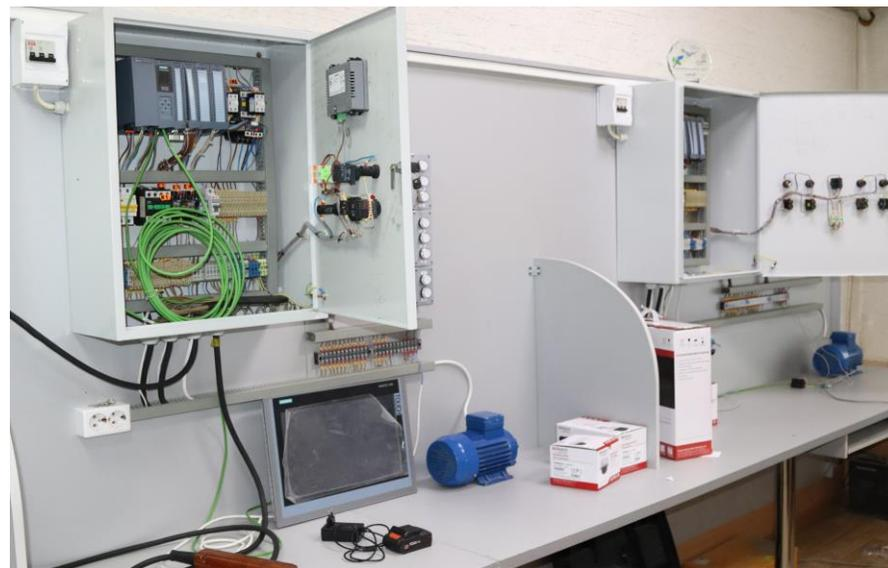
Станция распределения ввода и вывода «SIMATIC ET 200SP с модулями дискретного и аналогового расширения, IO link master, IO link module»
