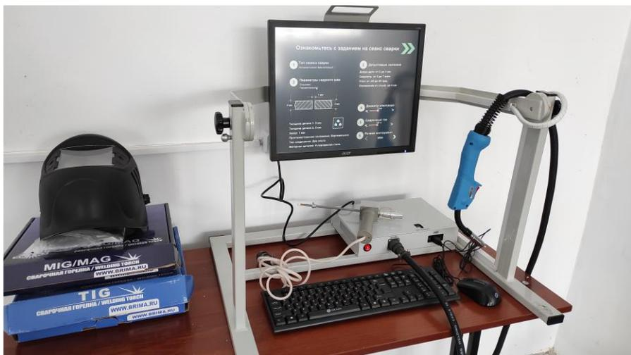
Виртуальный стенд «Сварочные работы TCB-6»
