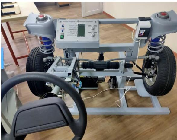
Лабораторный стенд «Рулевое управление с ЭУР»
