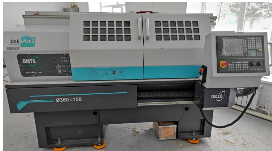
Токарный станок с ЧПУ «DMTG CKF-6136Z с системой управления Siemens»
