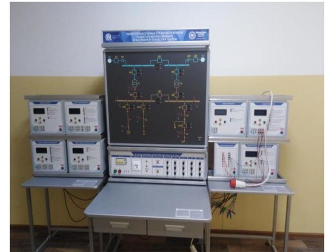
Комплект оборудования «Релейная защита и автоматизация электроэнергетических систем на основе микропроцессорной техники»
