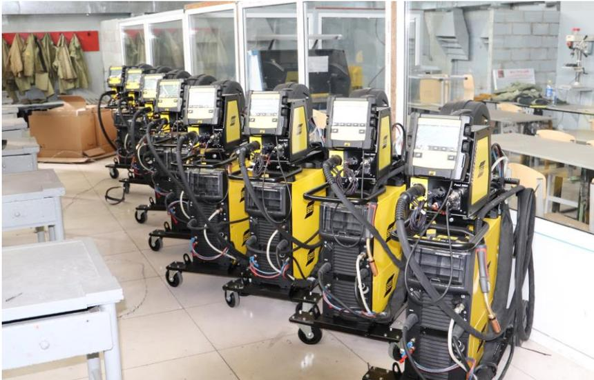
Инверторный источник тока для полуавтоматической сварки
