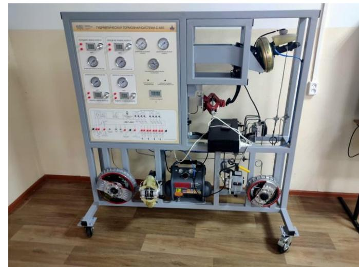
Лабораторный стенд «Тормозная система с ABS»
