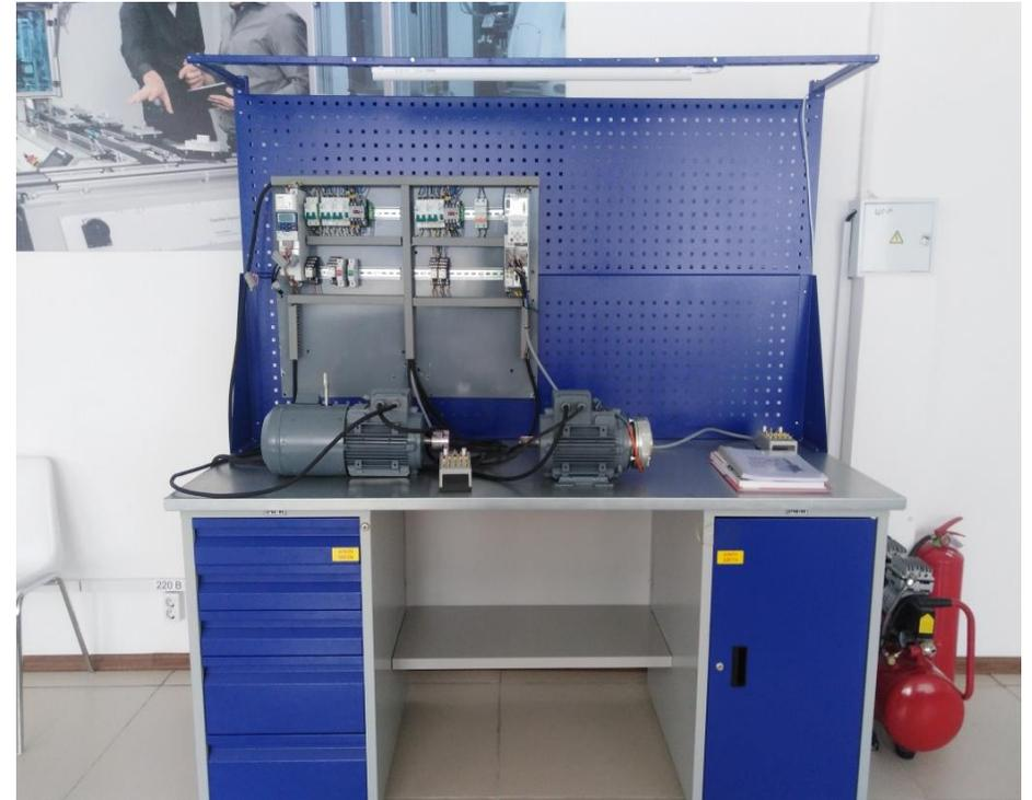
Учебный стенд «Электрический привод» с ПЛК (частотными преобразователями) LENZE
