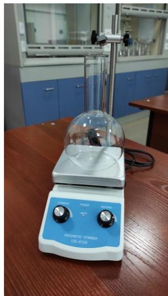
Лабораторная магнитная мешалка
