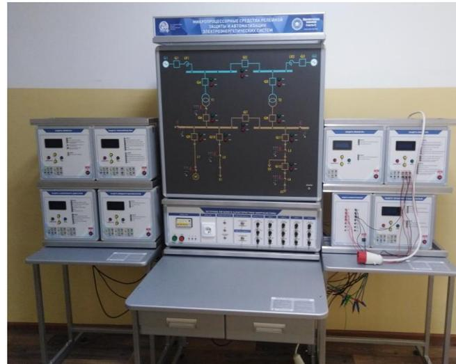
Комплект учебно-лабораторного оборудования «Микропроцессорные средства релейной защиты и автоматизации электроэнергетических систем»
