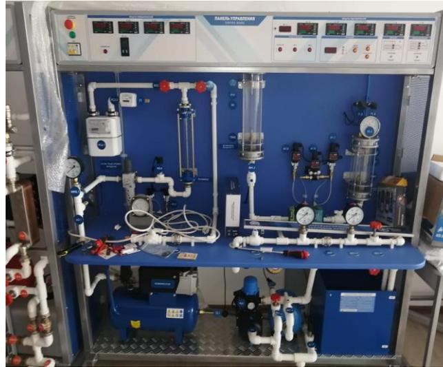
Лабораторный стенд «Измерение давлений расходов и температур в системах водо и газоснабжения»
