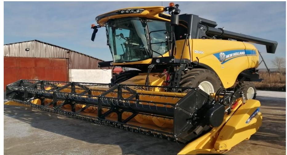
Зерноуборочный комбайн в комплекте с жаткой и платформой-подборщиком «New Holland CX5.90»
