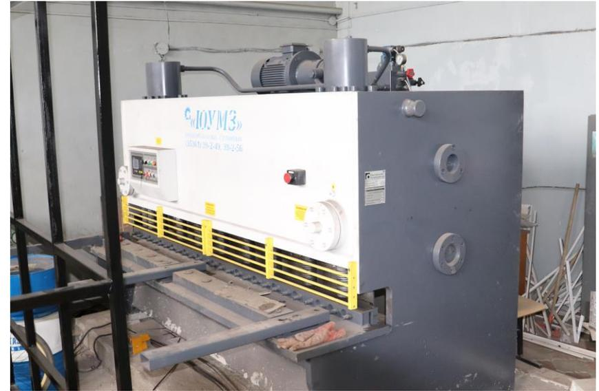
Аппарат для резки твердых металлов
