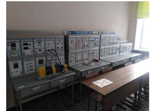
Комплект оборудования «Релейная защита и автоматизация электроэнергетических систем с генератором»
