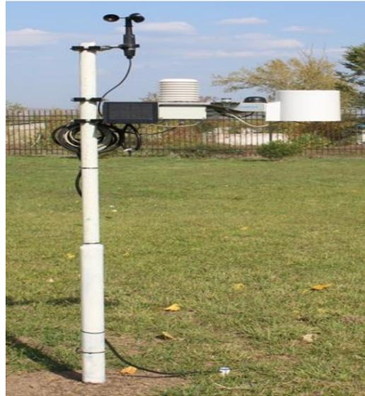
Беспроводная автономная погодная метеостанция с определением температуры почвы «iMetos Wetterstation»
